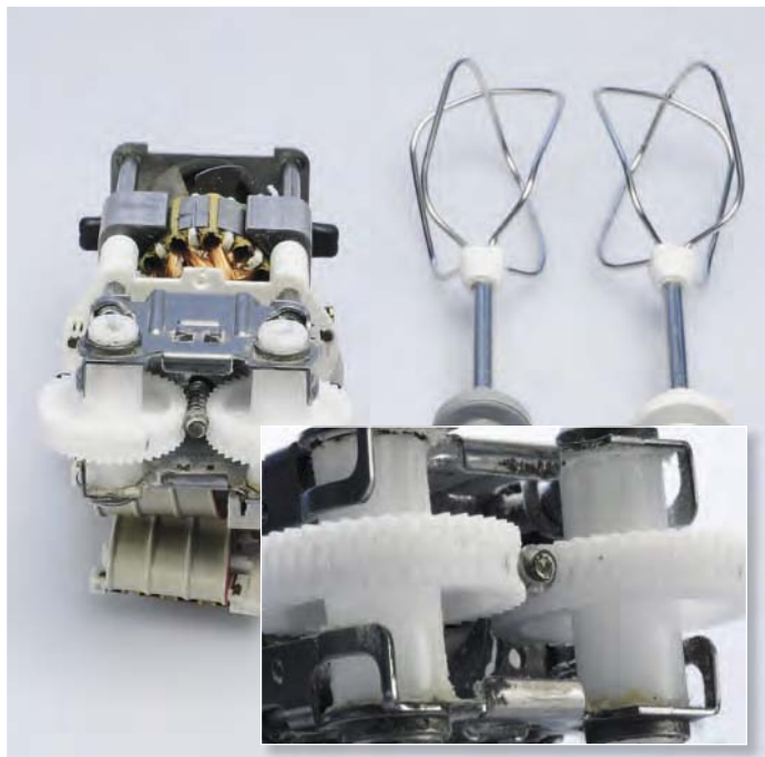
Wenn Plastezahnräder und Bauteile aus Metall ineinandergreifen, ist es nur eine Frage der Zeit, bis Erstere die Zähne verlieren.
