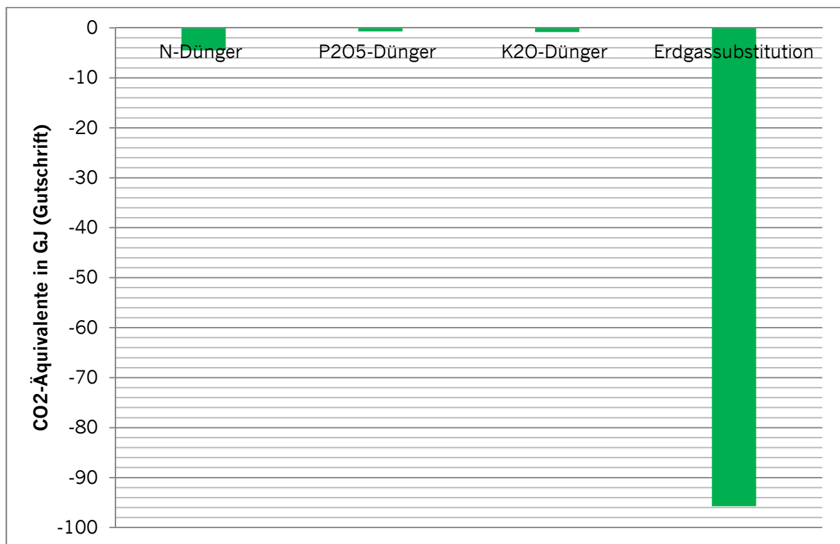
Abb. 12 (oben): CO 2 -Äquivalente der Gutschriften einer Biomethanerzeugung und –nutzung, in einer bestehenden KWK-Anlage (Substitution von Erdgas)
