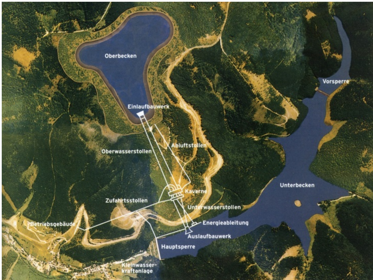
Abbildung 3: Luftbild des PSW Goldisthal mit Darstellung der wesentlichen Komponenten (Quelle: Vattenfall Europe AG)
