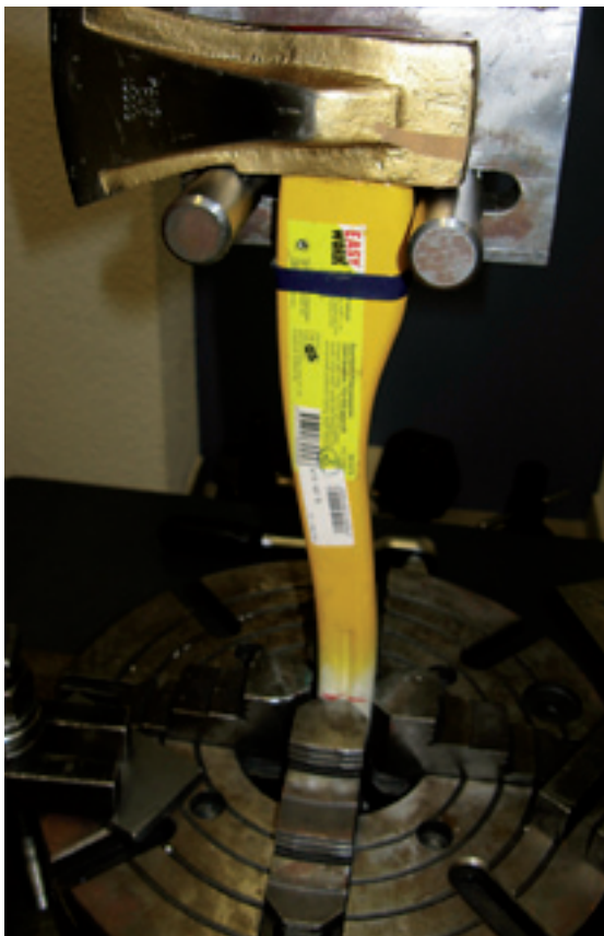
Bild 24: Zugprüfung beim Spaltbeil
