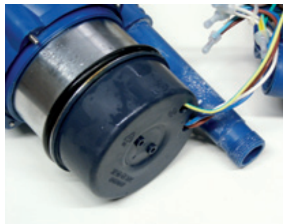
Bild 18: Wassereintritt nach Dichtheitsprüfung
