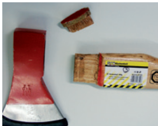
Bild 22: Küchenbeil nach der Prüfung
